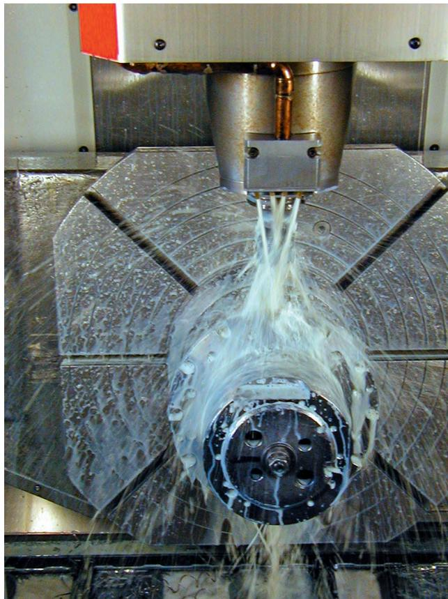
1 Kühlschmierstoffe aus der eni-aquamet-Reihe eignen sich als universelles Bearbeitungsmedium für das Fräsen, Bohren und Drehen verschiedener Werkstoffe (© Eni)
